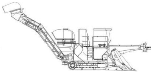
**Colhedora de forragem ou forrageira autoprovelida:** equipamento agrícola automotriz apropriado para colheita e forragem de milho, sorgo, girassol e outros. Executa o corte da planta, sendo capaz de colher ou recolher, triturar e recolher a cultura cortada em contentores ou veículos separados de transbordo.
